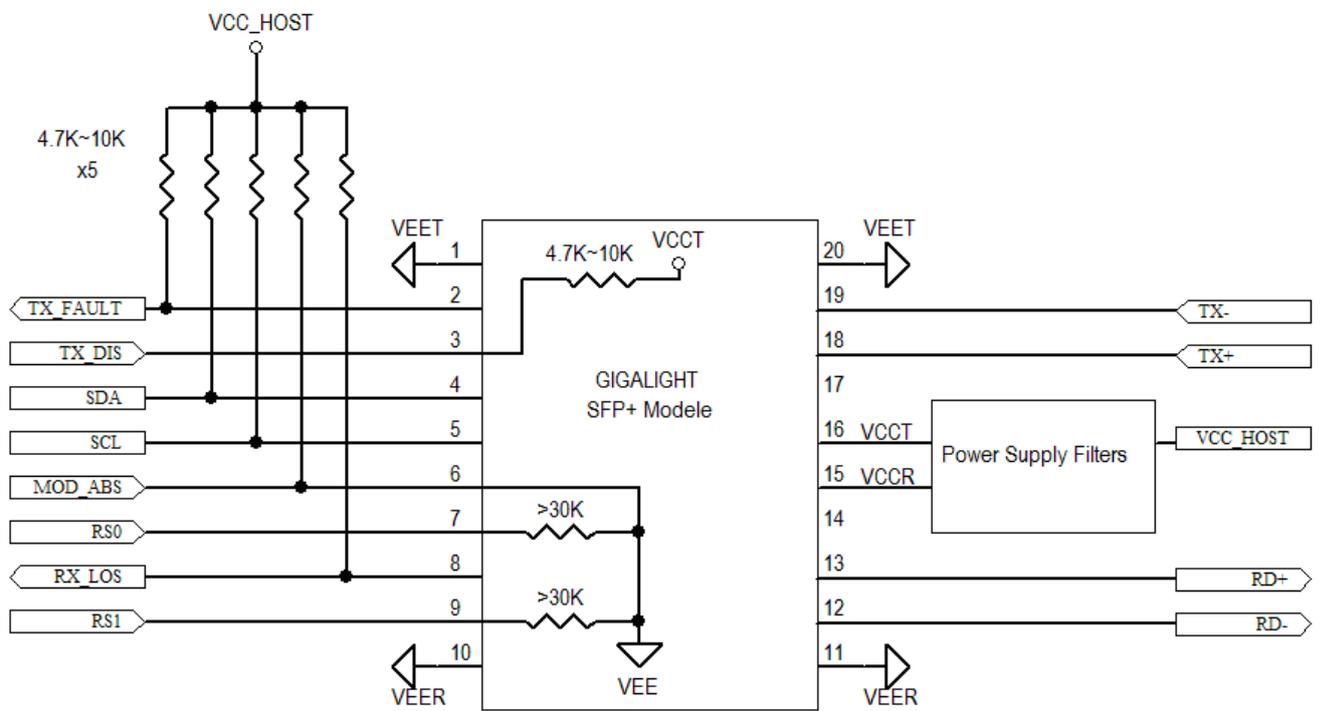
**Figure 4. Host-Module Interface**
