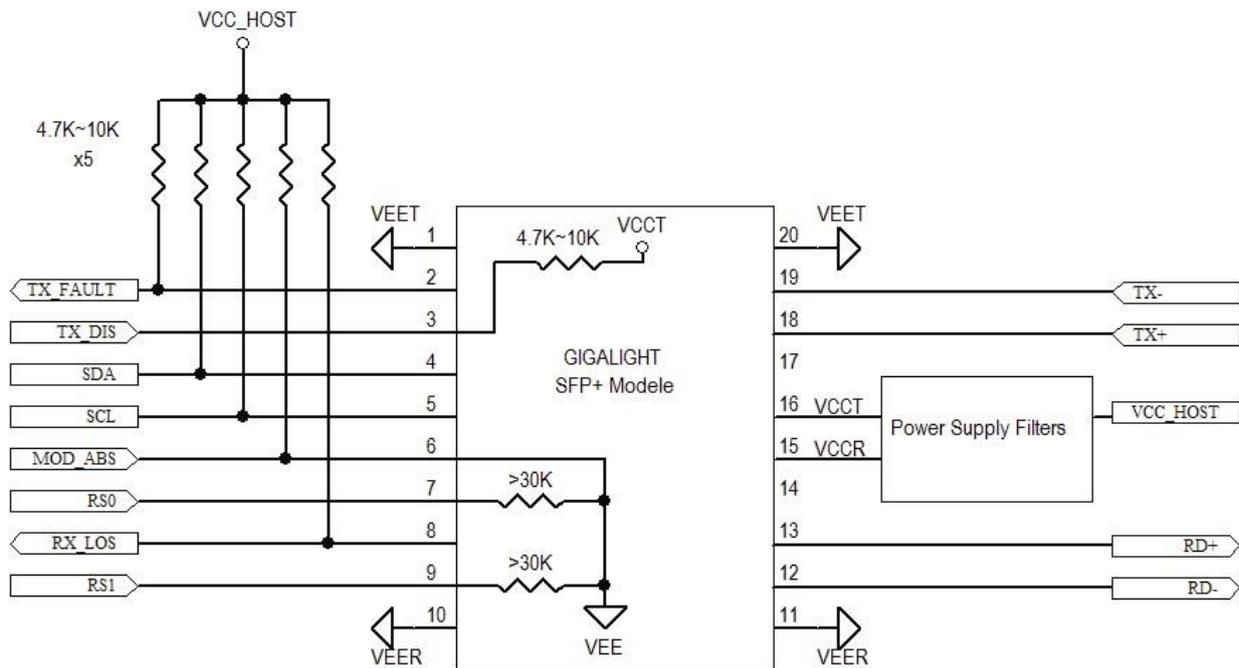
**Figure 4. Host-Module Interface**
