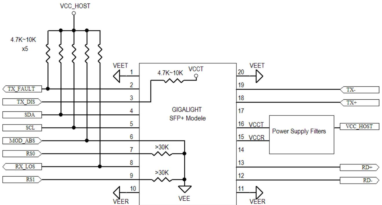
Figure 4. Host-Module Interface
