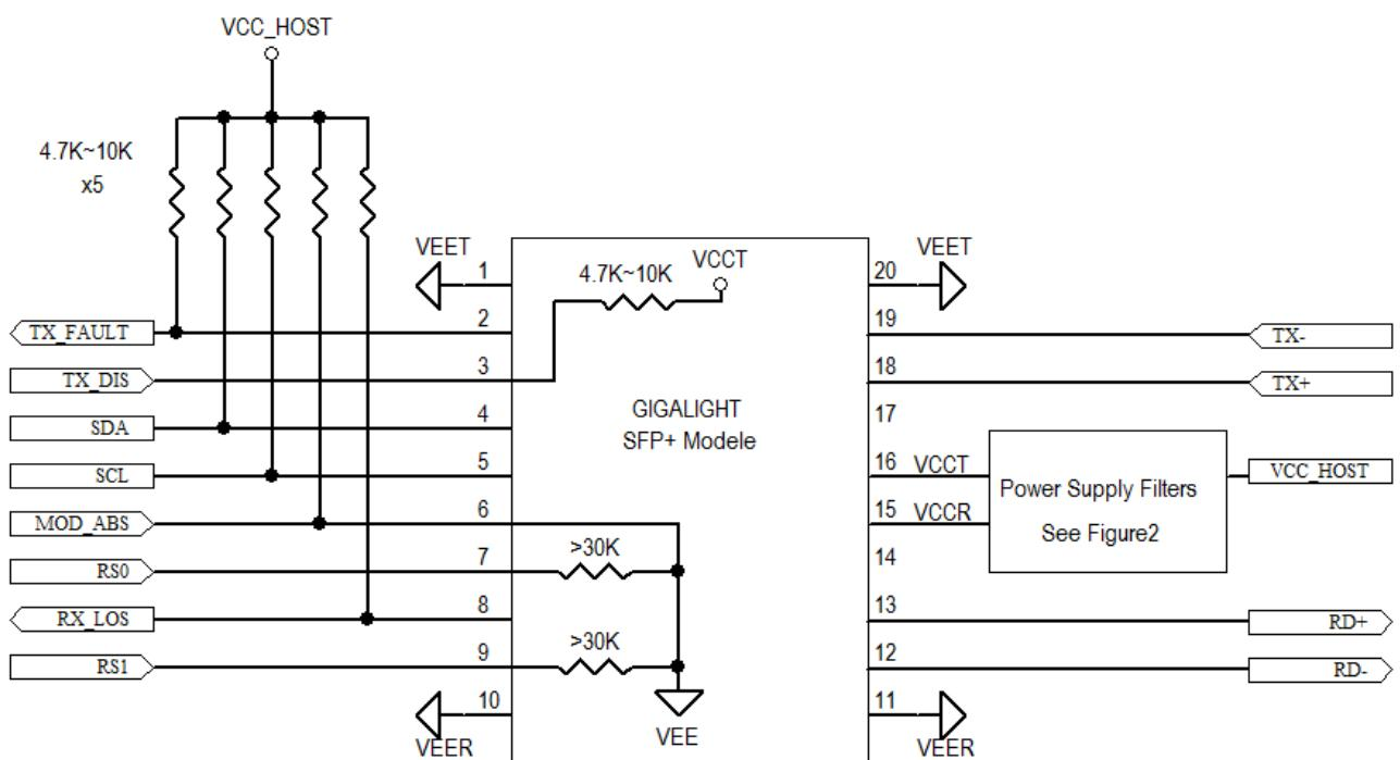
Figure 3. Host-Module Interface
