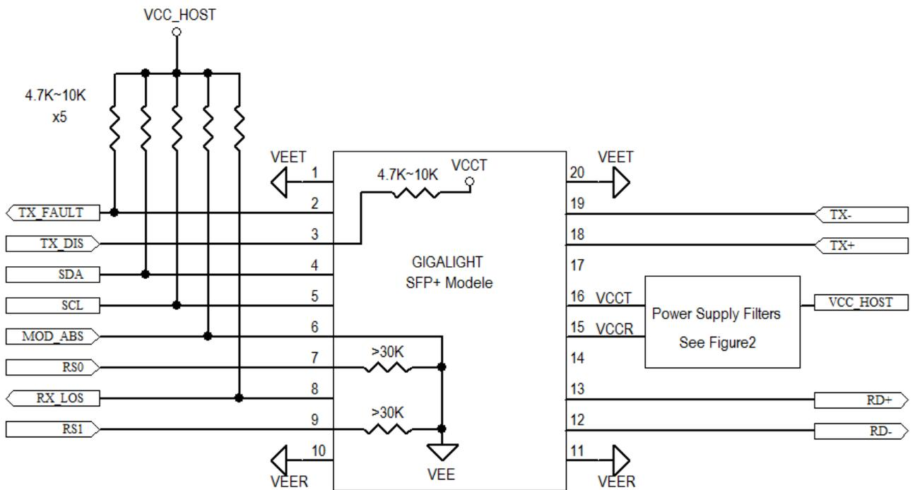
Figure 3. Host-Module Interface
