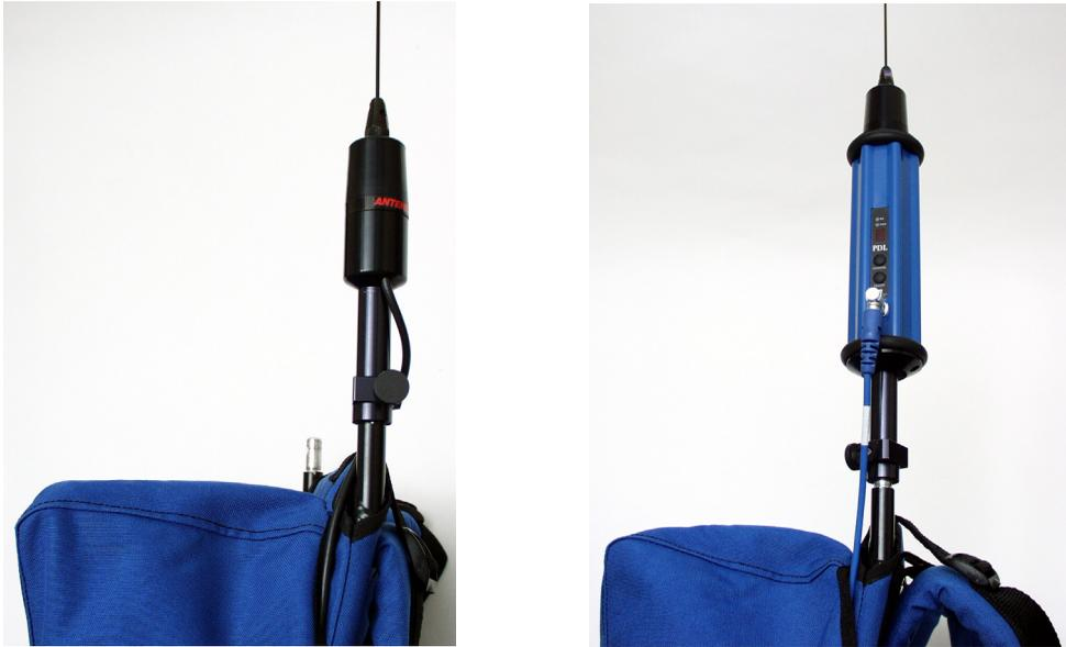
**Figura 4.9.** Antena de Radio Rover y Radio Pacific Crest PDL en la Mochila
