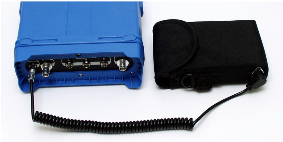
**Figura 3.10.** Cable de Alimentación del Receptor Conectando el Z-Xtreme y la Batería Externa
