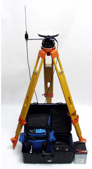
**Figura 4.6.** Sistema Base Listo para Medir
