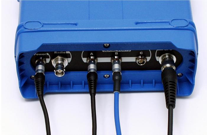
**Figura 3.22.** Conexiones de Cables de ZXtreme con Radio Externa
