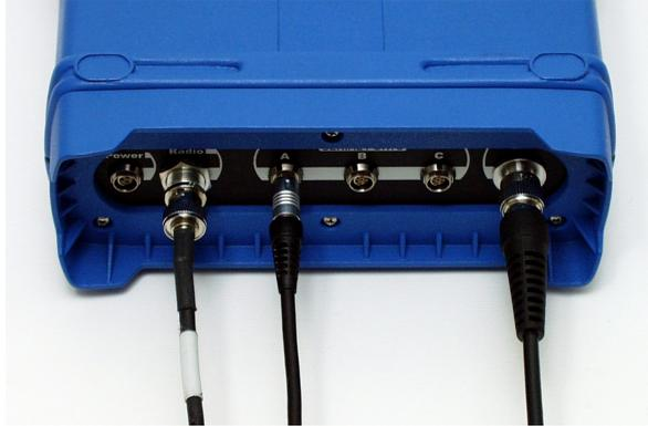
**Figura 3.29.** Receptor GPS Rover Totalmente Conectado y montado en el Jalón
