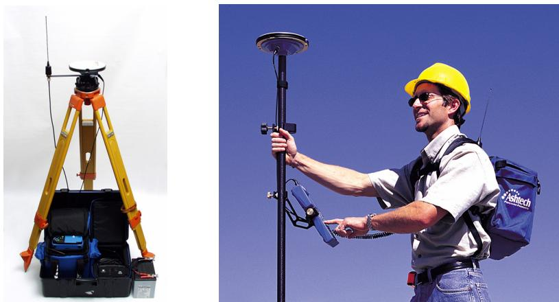
**Figura 1.1** Configuración RTK para Medición GPS
