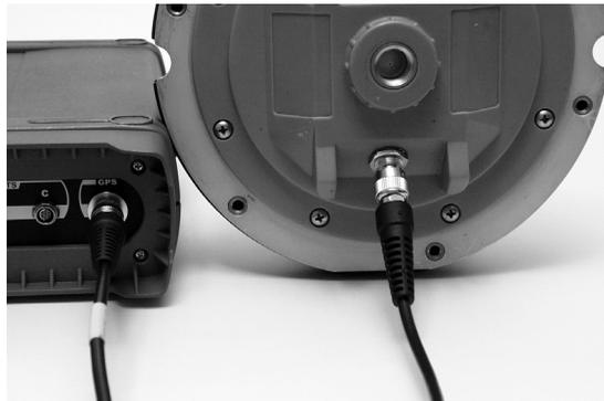
**Figura 3.2.** Cable para Antena GPS Conectado a Receptor Z-Xtreme y Antena Geodetic IV
