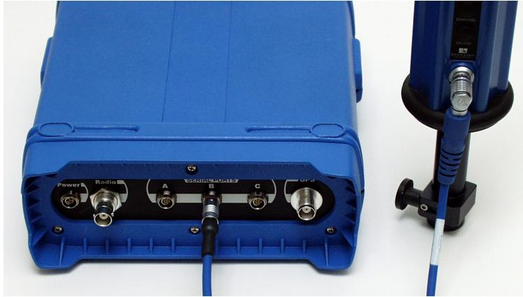
**Figura 3.20.** Cable de Comunicación que Conecta el receptor Z-Xtreme y la Radio Rover PDL
