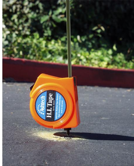
**Figura 4.5.** Midiendo la Altura de la Antena GPS Base
