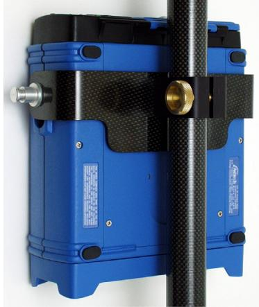
**Figura 4.13.** Receptor Montado en un Jalón
