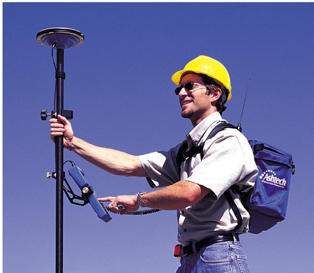
**Figura 4.14.** Sistema Rover con Mochila Listo Para Medir
