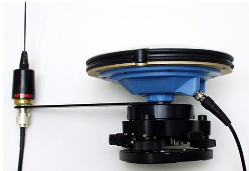
**Figura 4.4.** Antena de Radio Base Montada
