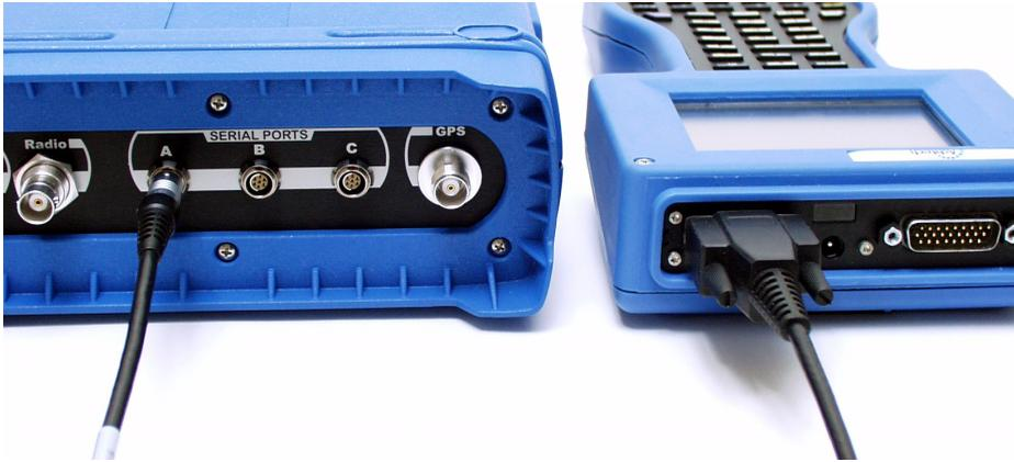
**Figura 3.8.** Cable de Comunicación del Computador Conectando al Z-Xtreme con la controladora Ranger
