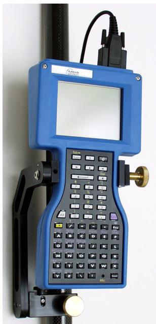
**Figura 4.12.** TDS Ranger Montada en el Jalón Rover
