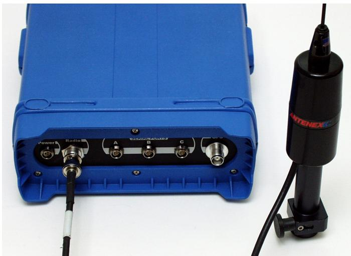
**Figura 3.17.** Antena Rover Conectada a la Radio Interna
