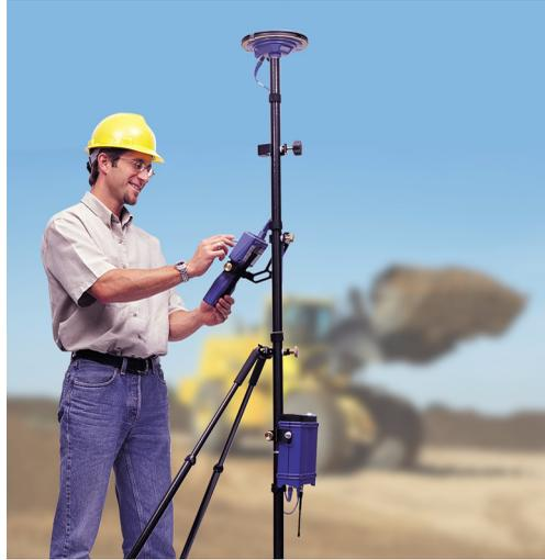
**Figura 4.15.** Sistema Rover con Configuración de Jalón Listo para Medir
