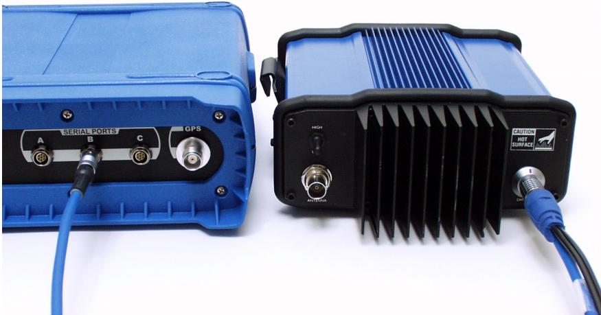
**Figura 3.6.** Cable de Comunicación de Radio, Conectado a la Radio Pacific Crest Base y al Receptor Z-Xtreme
