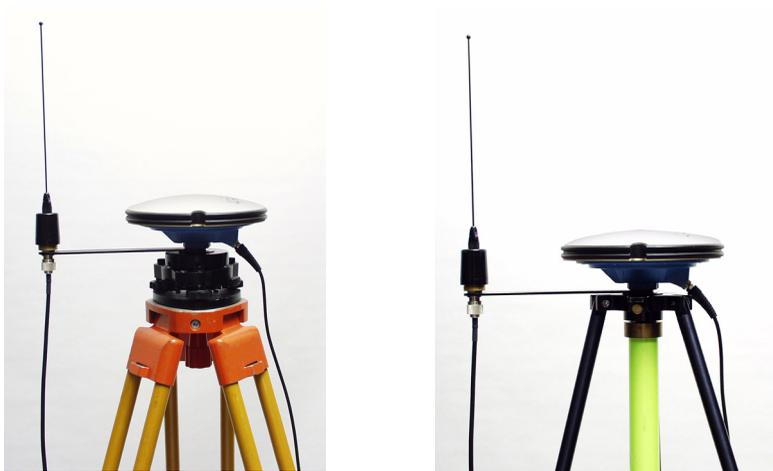
**Figura 4.3.** Antenas Base Montadas en Trípode Convencional y en Trípode GPS
