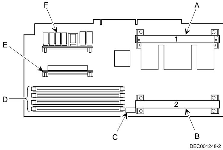
**Figure 3-9. Pentium II Processor Module Components**
