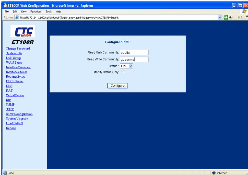
Figure 4-49 SNMP values input
